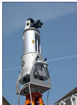
Figure 2 – Scanner Riegl LMS Z420i utilisé par la société ATM 3D.
